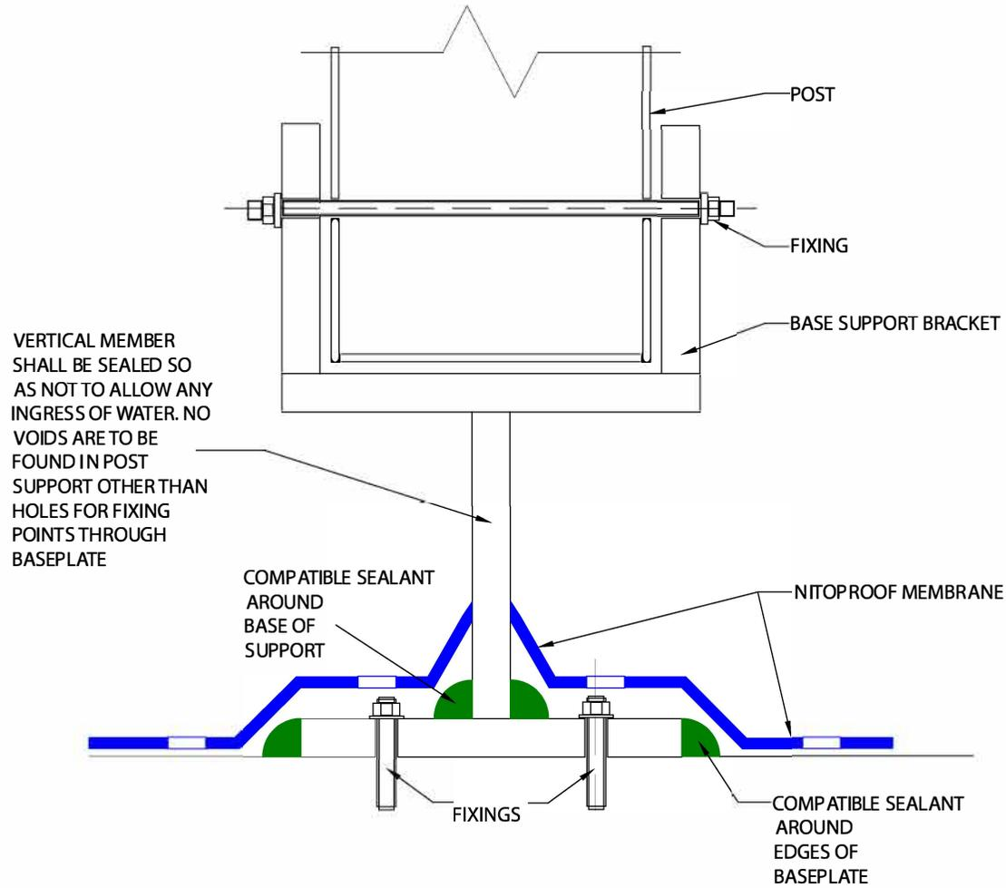
**NITOPROOF - DETAILING AROUND METAL POST SUPPORT**
