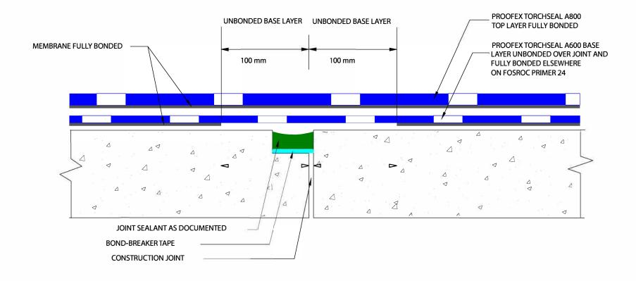
TYPICAL CONSTRUCTION JOINT DETAIL FOR 2 LAYER BITUMINOUS SHEET MEMBRANE
